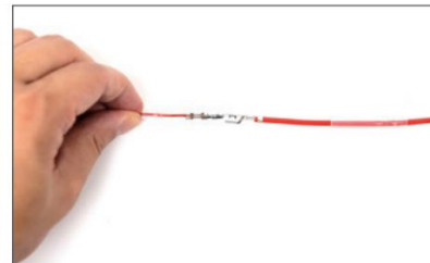
2. Illessze a csatlakozást a VCC+ kábelhez
